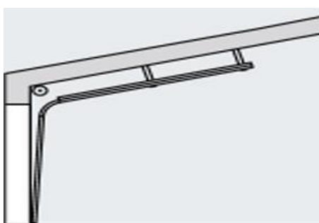
Направляющая ND со следованием по потолочному перекрытию
